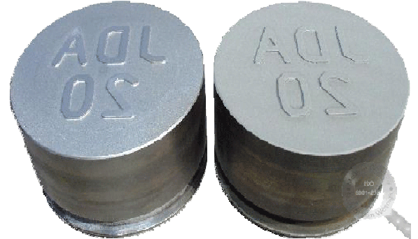
Matryca z powłoką z węgliku chromu która spowodowała znikomą zmianę wzoru natomiast 3-krotnie zwiększyła żywotności
